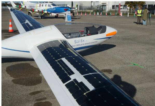
Il s'agit d'un planeur disposant d'un dispositif électrique d'envol à hélice incorporé (Moteur et hélice escamotables) avec une batterie embarquée rechargeable au sol, puis en vol à l'aide des panneaux solaires installés sur la voilure.
