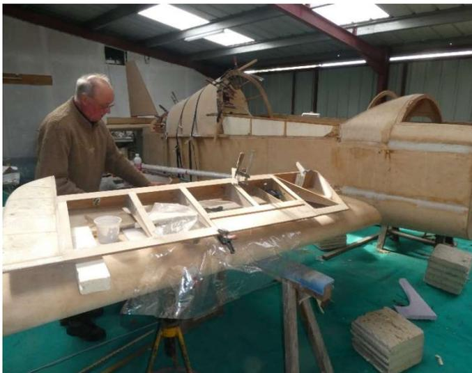
Le « Midour » est un monoplan à aile basse et train d'atterrissage fixe tricycle, spécialement conçu pour le remorquage.
