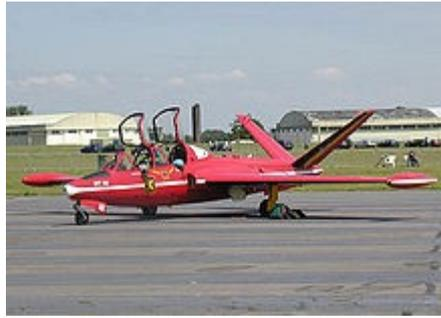
Sur certains modèles, l'empennage est composé de deux parties obliques, réalisant un empennage « papillon ».
