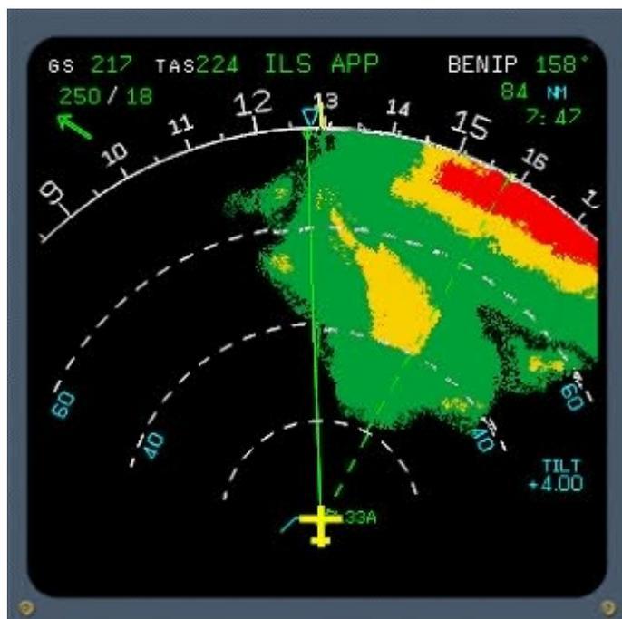
En 1982, le radar numérique a permis l'introduction de la couleur sur les écrans. Celle-ci restitue une image réelle en relief des orages, le pilote saura qu'il va rencontrer une zone de pluie avec turbulence légère ( en jaune ) ou bien une zone de pluie intense avec turbulence très forte ( en rouge ). Des échelles indiquent quelle route choisir, en fonction du rapprochement des orages, et permettent d'éviter le plus gros de la turbulence. ( trait vert continu )
