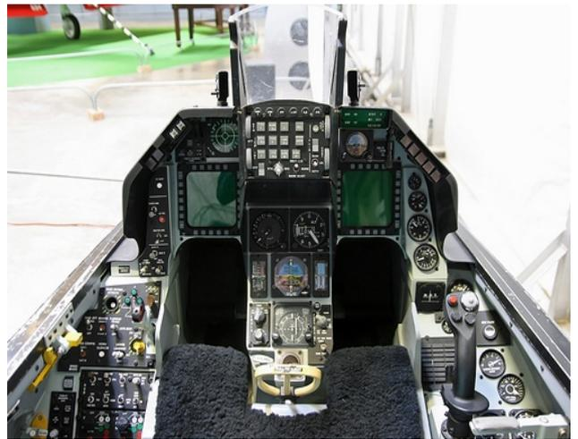
*Cockpit, le siège pilote est incliné à 30°*
